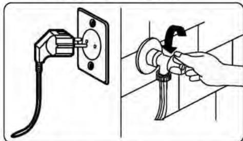
Avant toute opération d'entretien ou de nettoyage, il convient de couper l'alimentation secteur et de débrancher la prise de la machine.
