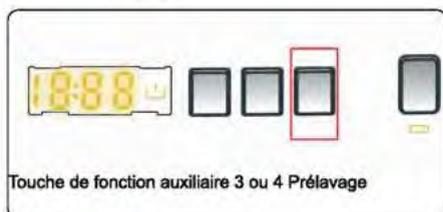
Pour un linge très sale, cette fonction permet d'initier un cycle de prélavage avant le démarrage du programme de lavage principal. L'utilisation de cette fonction nécessite d'ajouter de la lessive dans le compartiment prélavage du tiroir à produits lessiviels.
