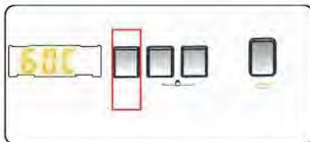
Lorsqu'un programme est sélectionné, la température maximale de ce dernier est automatiquement sélectionnée. Pour ajuster cette dernière, appuyer sur la touche de réglage de la température de l'eau jusqu'à ce que la valeur souhaitée s'affiche sur l'écran numérique.
